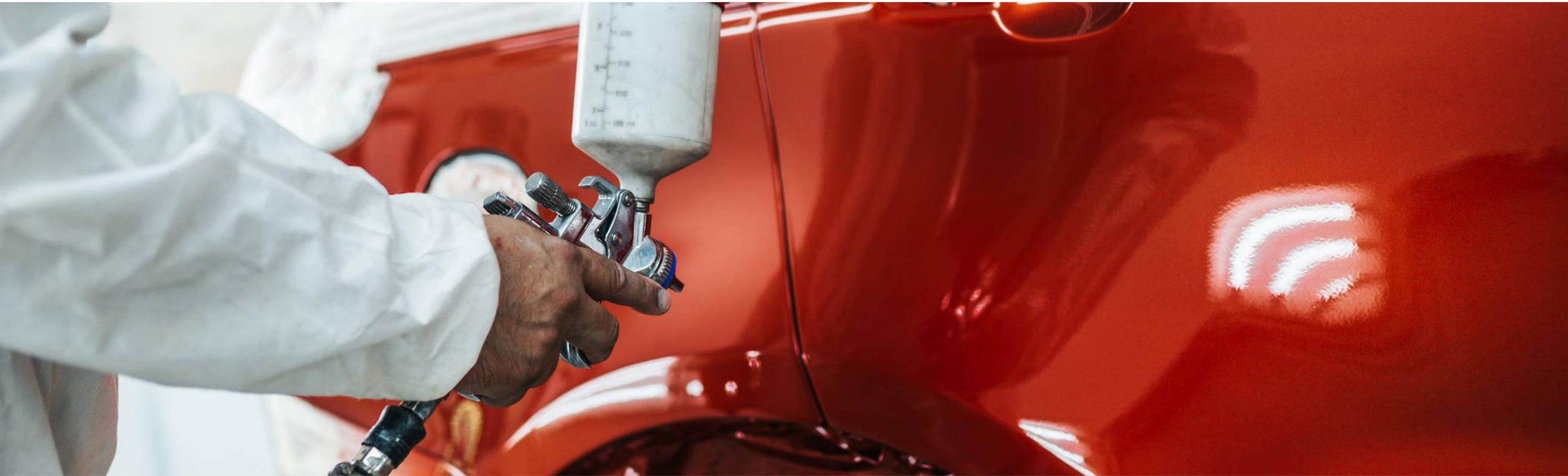
Dentre os principais equipamentos e **ferramentas da oficina** que toda funilaria precisa ter, na seleção de Carlos Alberto Souza, estão: o compressor, a lixadeira pneumática ou elétrica, a cabine de pintura, a máquina de solda e a pistola de pintura.
